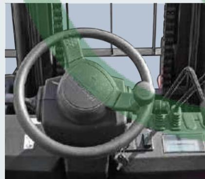
Маленький по диаметру руль и электрогидравлический задний ход, а также комбинированный переключатель с двумя ручками значительно улучшают комфорт при вождении.
