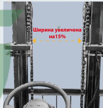
Увеличена внутренняя ширина мачты и расстояние между подъемными цилиндрами. Опускание инструментов в кабине значительно увеличило видимость; задняя видимость также значительно улучшилась за счет оптимизации конструкции противовеса.
