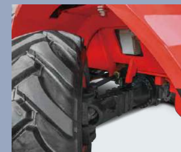
Качающаяся управляемая ось позволяет колесу преодолевать разные препятствия, сохраняя равновесие во время движения
