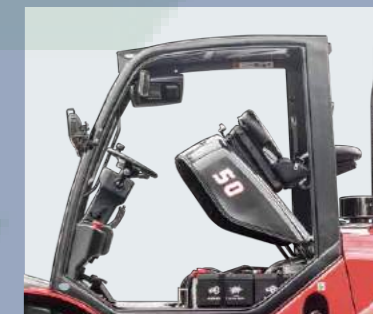
Легко открывающийся крючок обеспечивает быстрый доступ к моторному отсеку
