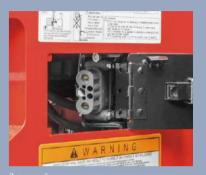
зарядныи штекер внутри отсека оператора, это устраняет необходимость отсоединять штекер от аккумулятора, повышая удобство эксплуатации (Std.)
